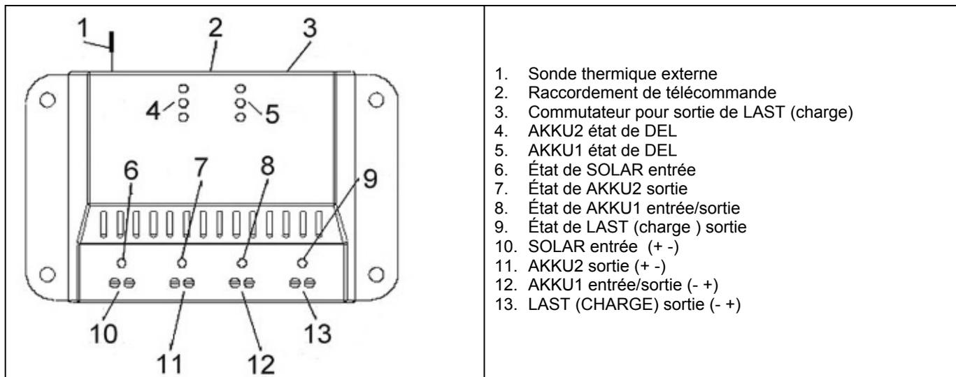
**Attention :** En cas d'erreur de polarité sur la sortie de charge, les appareils qui ne sont pas eux-mêmes protégés peuvent être abîmés. Les différents éléments consommateurs doivent être sécurisés individuellement.
