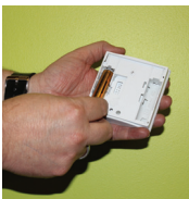
2. Legen Sie die beiden beigelegten AA Batterien ein. Sollten Sie zum ersten Mal ein ERT20RF installieren legen Sie das Thermostat zur Seite und fahren mit Seite 6 fort.
