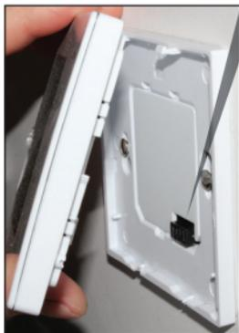
**1** Gehäusefront an der oberen Kante ansetzen.
