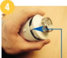
4 Bringen Sie das obere Gehäuse vorsichtig auf dem unteren Gehäuse an. Korrekte Ausrichtung zur Kenntnis nehmen.
