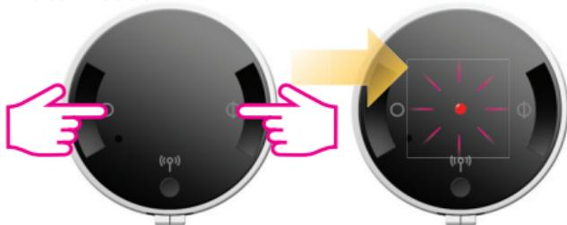
Ein kurzes Betätigen einer der beiden Tasten zeigt den Status an.
