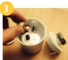
3 Setzen Sie die Batterien ein und bringen Sie die Batteriekappe wieder an. Bitte nehmen Sie die korrekte Batterieausrichtung zur Kenntnis.
