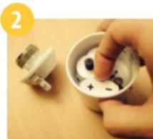
2 Entfernen Sie die Batteriekappe.
