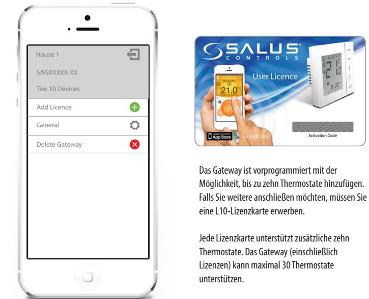
Das Gateway ist vorprogrammiert mit der Möglichkeit, bis zu zehn Thermostate hinzuzufügen. Falls Sie weitere anschließen möchten, müssen Sie eine L10-Lizenzkarte erwerben.
