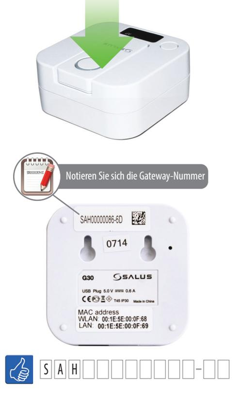
3. Verbinden Sie das Gateway durch eine der unten aufgeführten Methoden mit dem Internet
