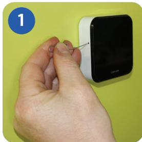
Um den iT300 mit dem iT500 zu verbinden, drücken Sie mit einer Büroklammer oder einem ähnlichen Objekt in das Loch auf der linken Seite des iT300 für ca. 2 Sekunden.
