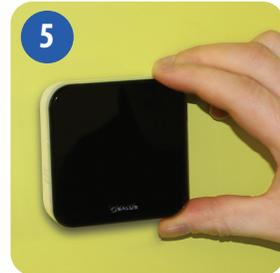
Stellen Sie sicher, dass der iT300 sicher befestigt ist.
