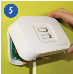
5 Klipsen Sie die Vorderseite des Empfängers wieder auf, bis diese einrastet.
