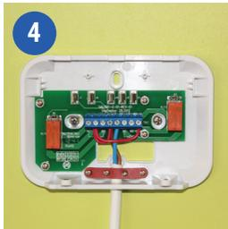
4 Den Empfänger mittels einem der Schaltpläne auf den Seiten 4 und 5 verdrahten.
