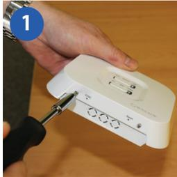
1 Lösen Sie die Schrauben an der Unterseite der Empfangs-Einheit.
