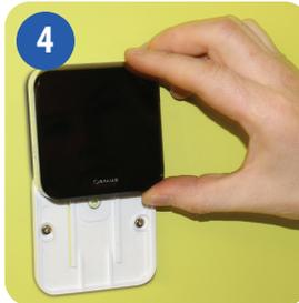
Setzen Sie den iT300 auf die Halterung bis diese sicher sitzt.
