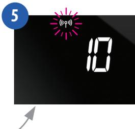
**i** **FAILSAFE-Modus:** Bei Ausfall des Funk-Signals wird Ihr System für 11 Minuten an-, dann für 4 Minuten ausgeschaltet werden. Wenn Sie den FAILSAFE-Modus deaktivieren möchten, wenn die Funkverbindung verloren gegangen ist, verschieben Sie den Schalter auf dem iT500RX entweder auf manual oder auf die off-Position.
