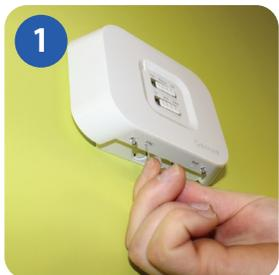
1 Drücken Sie mit einer Büroklammer in das Loch, das am unteren Rand des iT500RX-Empfängers gekennzeichnet ist. Dann gehen Sie wie auf der bildlichen Anleitung der nächsten Seite vor.
