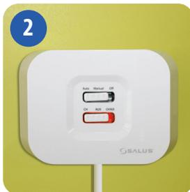
2 Der untere Schalter wird ein konstantes Rotlicht anzeigen, wenn der iT500RX-Empfänger zum Verbinden bereit ist. Widmen Sie sich jetzt dem iT500-Thermostat.
