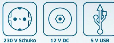
Schaltbare Lastausgänge sind gleichzeitig nutzbar. Während der Stromentnahme ist eine Aufladung möglich.
