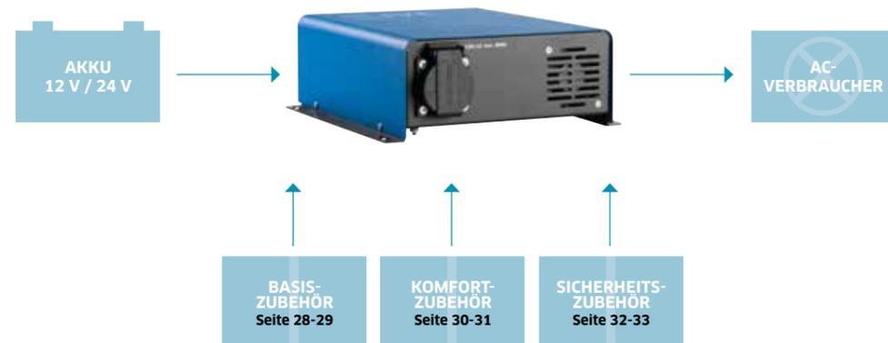
**Empfohlenes Zubehör:** Anschlusskabel, Zweitbatterielader, Fernbedienung, Schwingungsdämpfer
